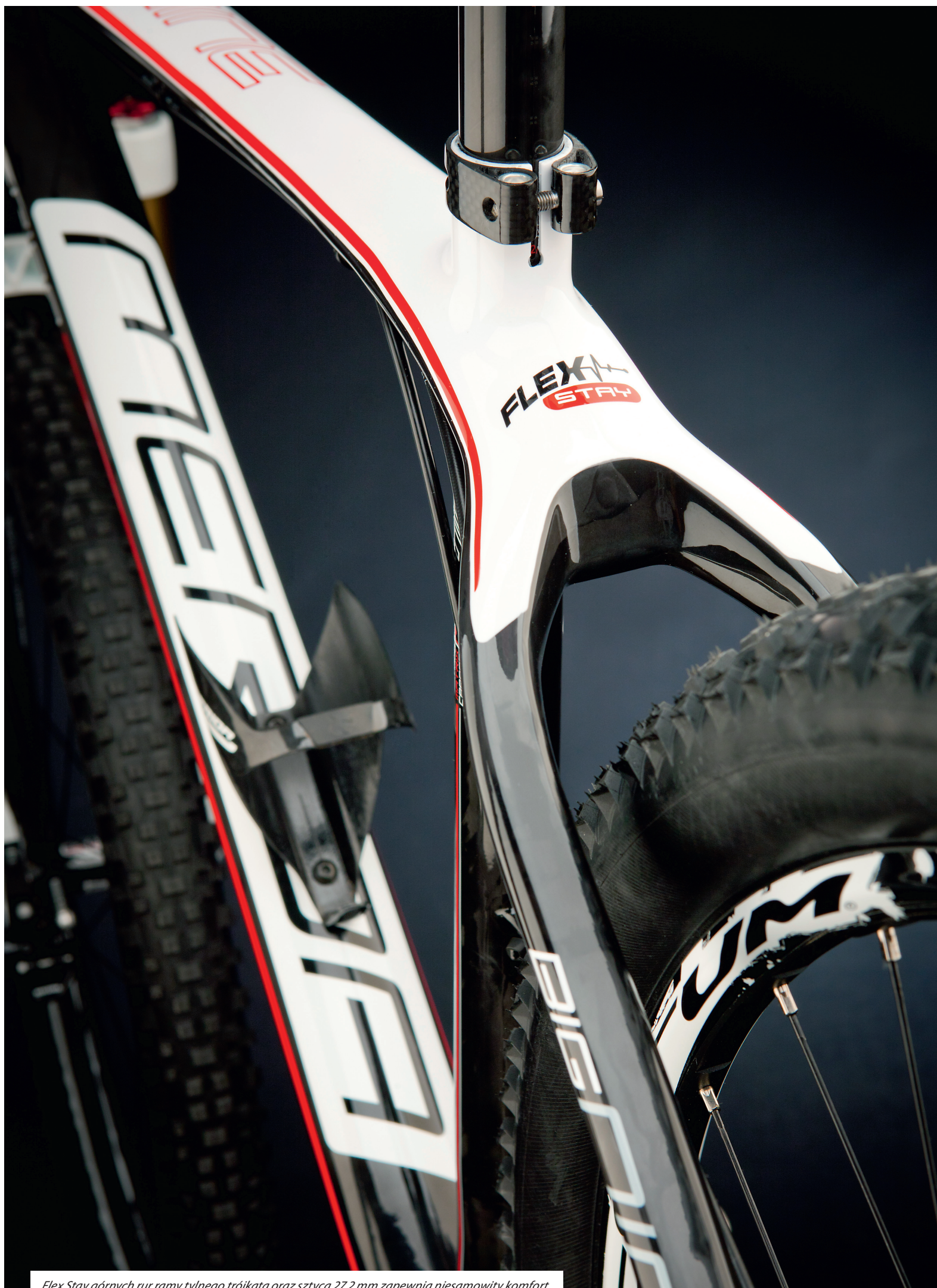
Flex Stay górnych rur ramy tylnego trójkąta oraz sztyca 27,2 mm zapewnia niesamowity komfort.
