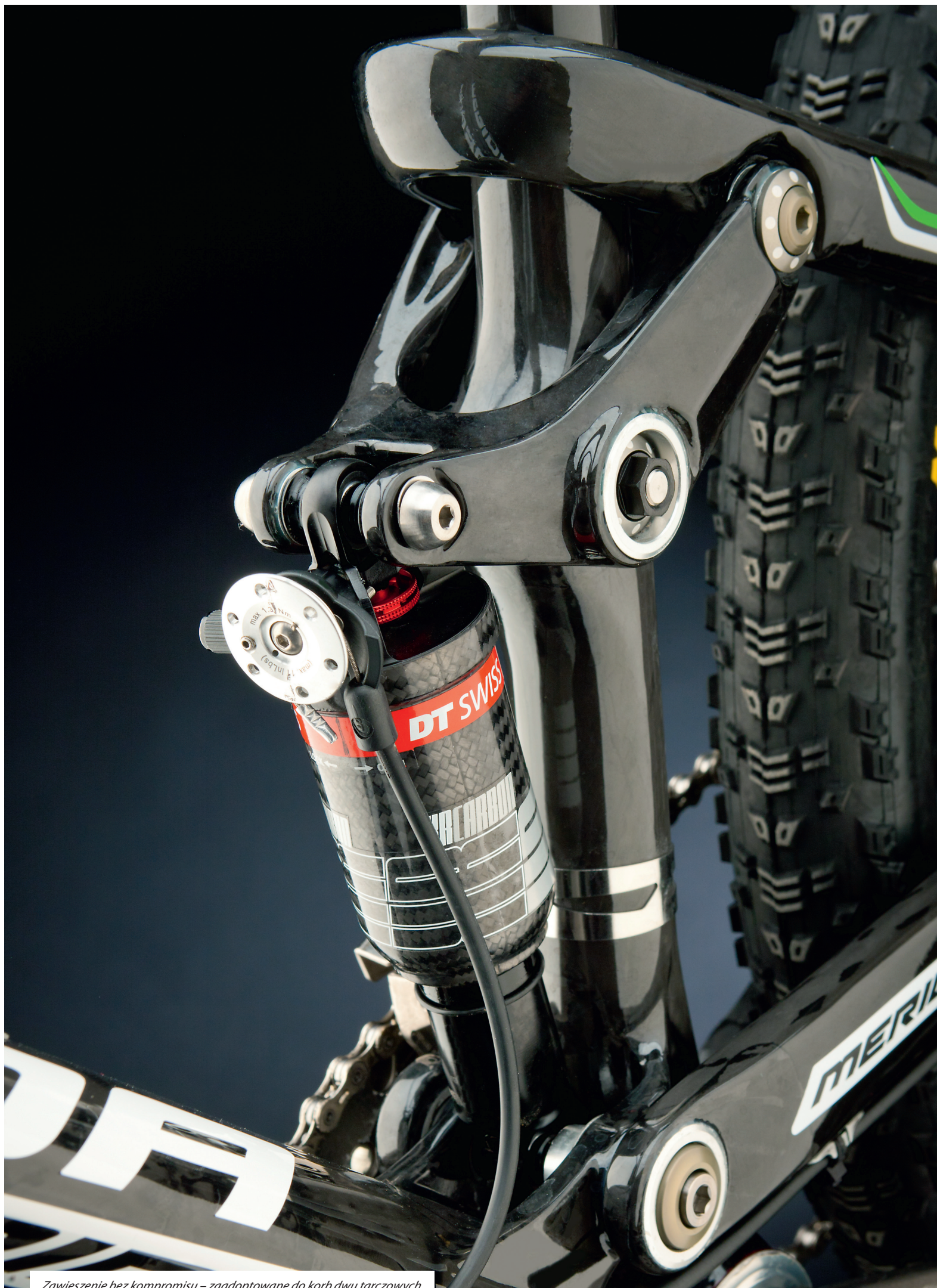
Zawieszenie bez kompromisu – zaadaptowane do korb dwu tarczowych.
